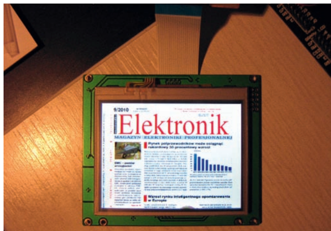
Rys. 6. Efekt obsługi graficznego wyświetlacza – wyświetlono na nim fragment okładki magazynu „Elektronik”
