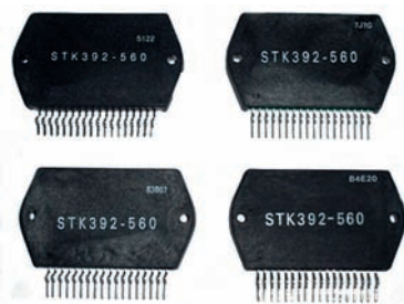
Rys. 2. Starsze, ale nadal poszukiwane układy scalone coraz rzadziej są oryginalne
