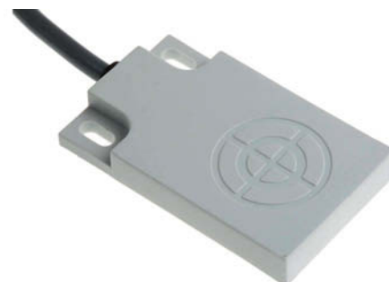
Rys. 8. W typowym pojemnościowym czujniku zbliżeniowym (po lewej) metalowa płytka czujnikowa tworzy z zewnętrznym obiektem docelowym kondensator. Wartość tej pojemności określa częstotliwość oscylatora. Po prawej pokazano czujnik CD50CNF06NO tego typu firmy Carlo Gavazzi przeznaczony do monitorowania poziomu cieczy
