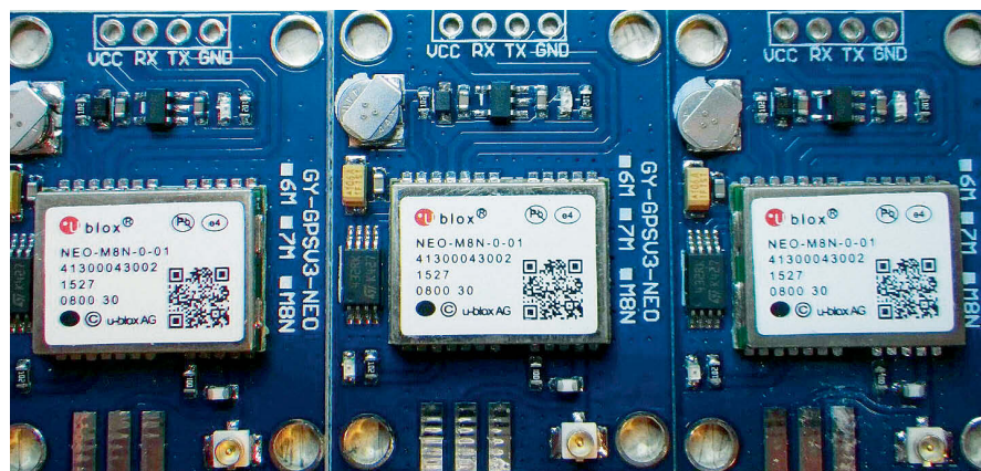
Rys. 1. Wiele tanich modułów (w tym te GPS-y pokazane na zdjęciu) zawiera podrabiane układy
