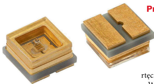
Rys. 4. Dioda LED UV-C 277 nm firmy Vishay w obudowie ceramicznej o wymiarach 3,45×3,45×1,78 mm z kwarcowym okienkiem
