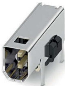
Rys. 2. Modułowe gniazdo SPE 1163797 firmy Phoenix Contact jest kompatybilne ze wszystkimi aktualnymi standardami SPE. Jego obciążalność sięga 72 V przy 4 A
