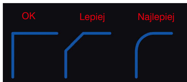
Rys. 1. Rekomendowany sposób prowadzenia ścieżek
