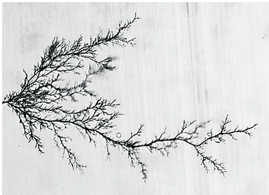
Rys. 4. Tworzenie się dendrytów (proces rozgałęziania) na izolatorze wzdłuż ścieżki upływu
