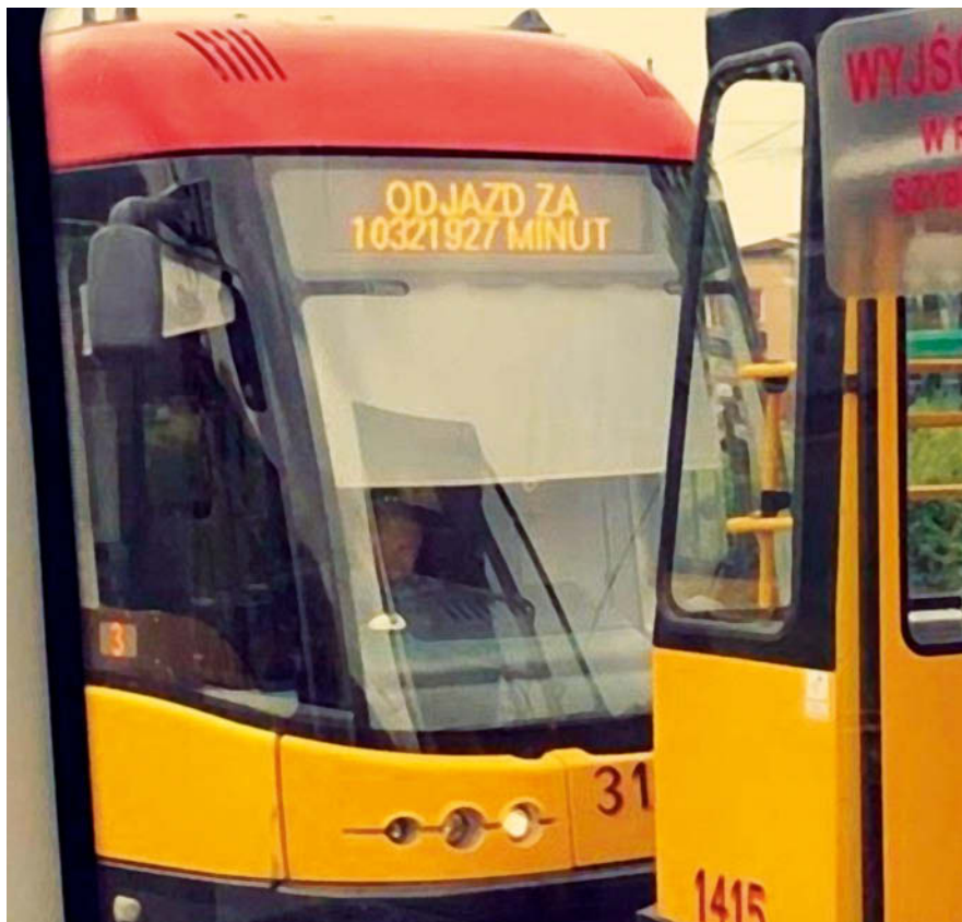
Fot. 2. Awaria telemetrii w tramwajach w dniu 7.04.2019 r spowodowana problemem przepięcia i wyzerowania się licznika tygodni. Licznik jest częścią danych telemetrycznych przekazywanych z satelitów GPS i występuje raz na 19,7 lat (10321927 minut)
