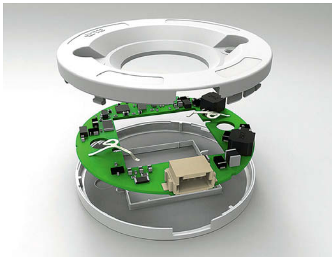
Rys. 2. Integracja zasilacza 48 V w uchwycie COB LED nie oznacza utraty jakości oraz niezawodności źródła światła
