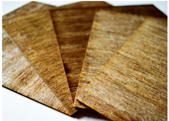
Rys. 3. Jiva – przykład w pełni biodegradowalnego materiału do konstrukcji podłoża PCB
