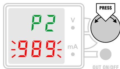
При этом выход источника выключен, его включение кнопкой OUT ON/OFF заблокировано. По умолчанию точка 2 задана на 0.01 А ниже верхнего предела шкалы. Например, для источника с максимальным током 999 мА значение калибровочной точки 2 по умолчанию равно 989 мА. Значение точки можно менять поворотом ручки энкодера. Оно может лежать в диапазоне от 100 мА и до максимального выходного тока БП. К выходу источника
