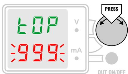
ручки энкодера. При этом на дисплее появится надпись «tOP x.xx», где мигающие цифры x.xx обозначают установленное значение предела для тока. Вращением ручки энкодера значение предела можно менять. Шаг перестройки составляет 1 мА. При быстром вращении ручки энкодера шаг автоматически увеличивается до 10 мА. Когда требуемое значение установлено, нужно нажать ручку энкодера. При этом значение предела будет
