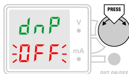
кнопкой OUT ON/OFF отключается и DP, поэтому при наличии фильтрующих емкостей напряжение может падать довольно медленно. Если требуется быстрый спад напряжения, то можно разрешить работу DP при отключении выхода. Для этого необходимо в меню установить «dnP On». Тогда при выключенном выходе и наличии напряжения на нагрузке источник будет
