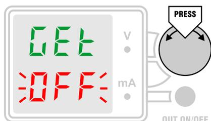
Данный режим может быть полезен в тех случаях, когда требуется контролировать напряжение на выходе источника в выключенном состоянии, например, при наличии внешних источников тока. Фактически, этот режим позволяет использовать БП в качестве вольтметра. При обычном использовании источника этот режим рекомендуется выключить («Get OFF»).
