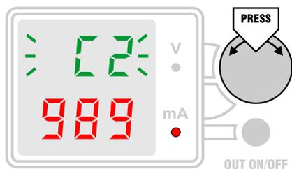
Одновременно считывается текущий код АЦП, который принимается в качестве кода для тока P2. На основе этого кода производится перерасчет калибровочных коэффициентов АЦП. Затем выход источника автоматически отключается. Калибровка АЦП обновляется только в том случае, если производилась регулировка кода C2. На этом этап калибровки тока завершен. Если при завершении этого шага калибровки
