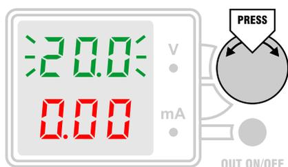
Для быстрого входа в режим установки напряжения в меню можно включить режим Output Track (trc On). Тогда вход будет производиться простым поворотом ручки энкодера.
