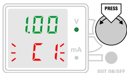
большее количество знаков, чем дисплей БП, такой подход позволяет более точно установить код ЦАП для калибровочной точки. Когда выходное напряжение источника будет установлено равным значению точки P1 с максимально возможной точностью, данный шаг калибровки можно завершить. Для перехода к следующему шагу нужно нажать ручку энкодера. При этом установленное значение кода C1 запоминается и
