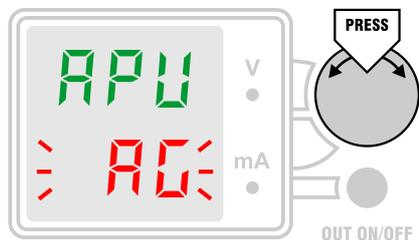
«APU PH» (индикация максимальных пиковых значений напряжения) и «APU PL» (индикация минимальных пиковых значений напряжения). При индикации пиковых значений зарегистрированный экстремум показаний удерживается на индикаторе 1 сек., после чего снова происходит переход к индикации текущего пикового значения. Время интегрирования для пиковых значений составляет 1 мс.
