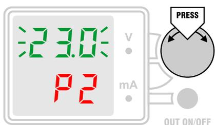
«P2». При этом выход источника выключен, его включение кнопкой OUT ON/OFF заблокировано. По умолчанию точка 2 задана на 1 В ниже верхнего предела шкалы. Например, для источника с максимальным напряжением 24 В значение калибровочной точки 2 по умолчанию равно 23.0 В. Значение точки можно менять поворотом ручки энкодера. Оно может лежать в диапазоне от 9.00 В и до максимального выходного напряжения БП. К выходу
