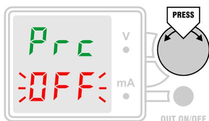
можно включить режим предпросмотра установленного тока ограничения, когда его значение будет всегда индицироваться на дисплее при отключенном выходе. Для этого необходимо в меню установить «PrC On». Такой вариант индикации тока ограничения является довольно распространенным для лабораторных БП с цифровым управлением.
