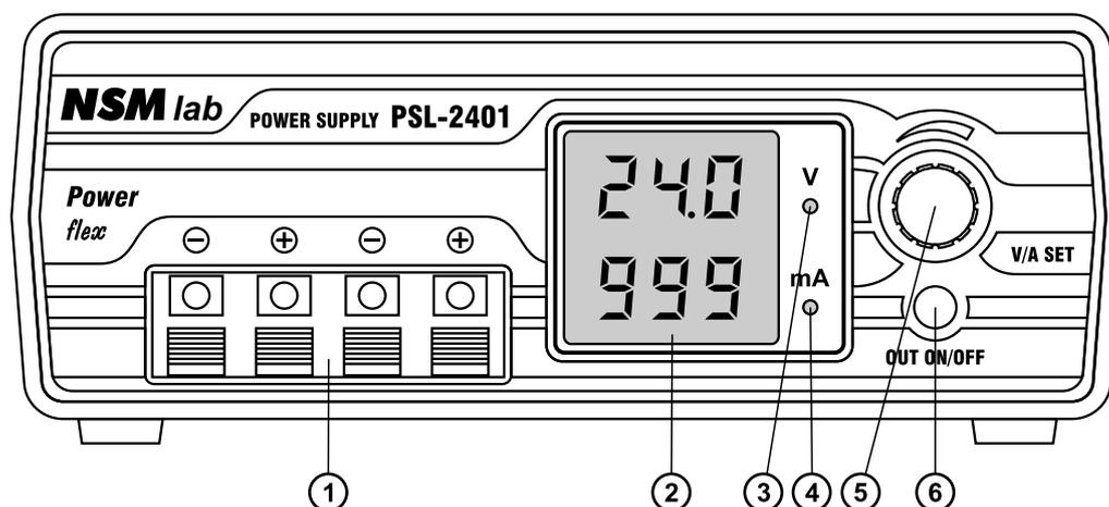
**Рис. 1. Передняя панель источника.**
