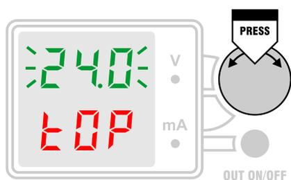
ручку нужно в тот момент, когда на дисплее появится надпись «xx.x tOP», где мигающие цифры xx.x обозначают установленное значение предела для напряжения. Если ручку удерживать дольше, то произойдет переход в основное меню. Вращением ручки энкодера значение предела можно менять. При напряжении ниже 10 В шаг перестройки составляет 0.01 В, при напряжении выше 10 В шаг составляет 0.1 В. При быстром вращении ручки
