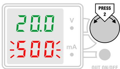
тока ограничения, нужно нажать ручку энкодера еще раз, при этом значение тока ограничения на дисплее мигать перестает. Если регулировка не производится дольше 5 сек., то происходит автоматический выход из режима установки тока.
