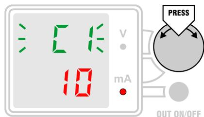
установлен равным значению точки Р1 с максимальной возможной точностью, данный шаг калибровки можно завершить. Для перехода к следующему шагу нужно нажать ручку энкодера. При этом установленное значение кода С1 запоминается и производится перерасчет калибровочных коэффициентов ЦАП с учетом нового значения. Одновременно считывается текущий
