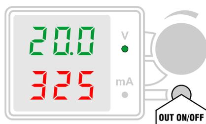
Когда выход включен, в режиме CV отображается установленное значение напряжения и измеренное значение тока. В режиме CC – измеренное значение напряжения и установленное значение тока. Такой режим отображения может быть отключен из меню. Для этого нужно выбрать отключение индикации установленных значений (Set OFF). В этом случае всегда будут индицироваться измеренные значения.
