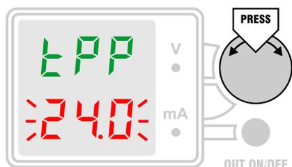
Максимальное значение мощности используется в качестве верхнего предела для порога защиты от превышения мощности OPP. Когда эта защита включена, при превышении выходной мощности источника его выход будет автоматически отключен, что защищает нагрузку от превышения рассеиваемой мощности и сам источник от перегрузки.
