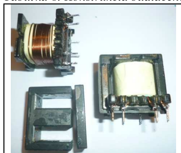
Tabuľka 8. Konštrukcia budiaceho transformátora TR1.
