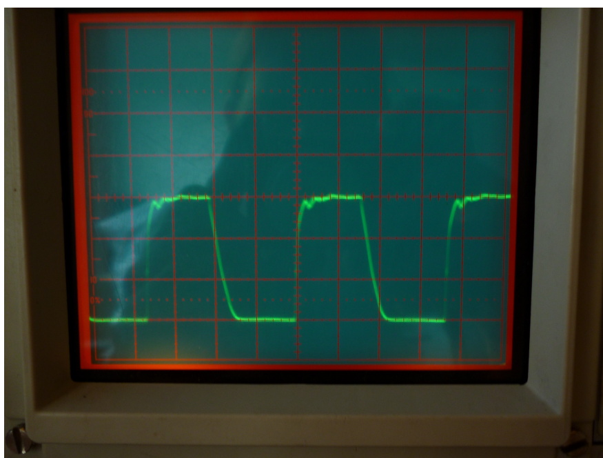
obr. 21: Napätie U_{gs} , 5 V/div; 2 \mu s/div
