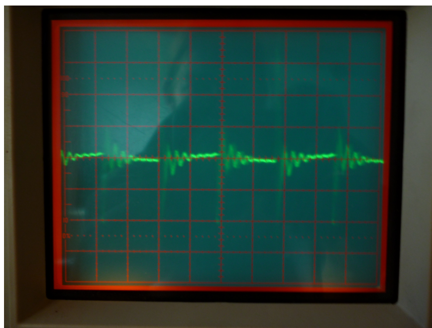
obr. 19: Výstupné napätové zvlnenie, 10 mV/div; 2 us/div
